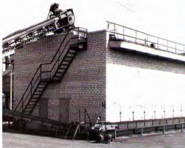
Рис. 2. Сушилка камерная для сушки семенных початков кукурузы
